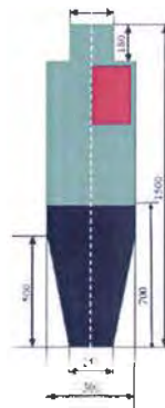
Рис. 86. Комбинированная мишень для выполнения метания ножа и малой пехотной лопаты на точность с места
